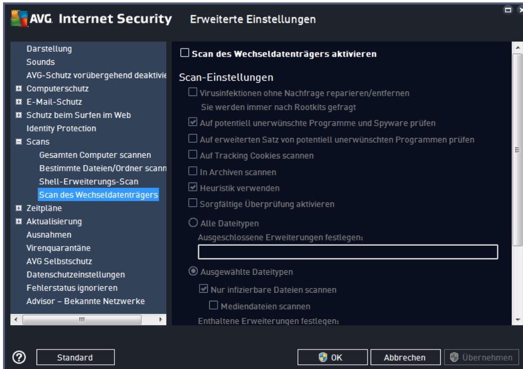
Der **Scan des Wechseldatenträgers** wird automatisch gestartet, sobald Sie einen Wechseldatenträger an Ihren Computer anschließen. Standardmäßig ist dieser Scan deaktiviert. Es ist jedoch entscheidend, Wechseldatenträger auf potentielle Bedrohungen zu scannen, da diese die Hauptquelle von Infektionen sind. Aktivieren Sie das Kontrollkästchen **Scan des Wechseldatenträgers aktivieren**, damit dieser Scan bereit ist und bei Bedarf automatisch gestartet werden kann.
