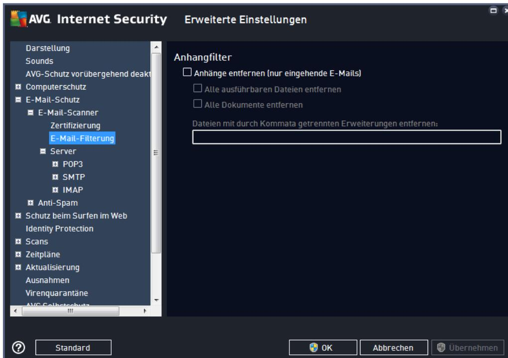
Im Dialog **Anhangfilter** können Sie Parameter für das Scannen von E-Mail-Anhängen festlegen. Standardmäßig ist die Option **Anhänge entfernen** deaktiviert. Wenn Sie die Option aktivieren, werden alle E-Mail-Anhänge, die als infiziert oder potenziell gefährlich erkannt werden, automatisch entfernt. Wenn Sie möchten, dass nur bestimmte Arten von Anhängen entfernt werden, wählen Sie die entsprechende Option aus:
