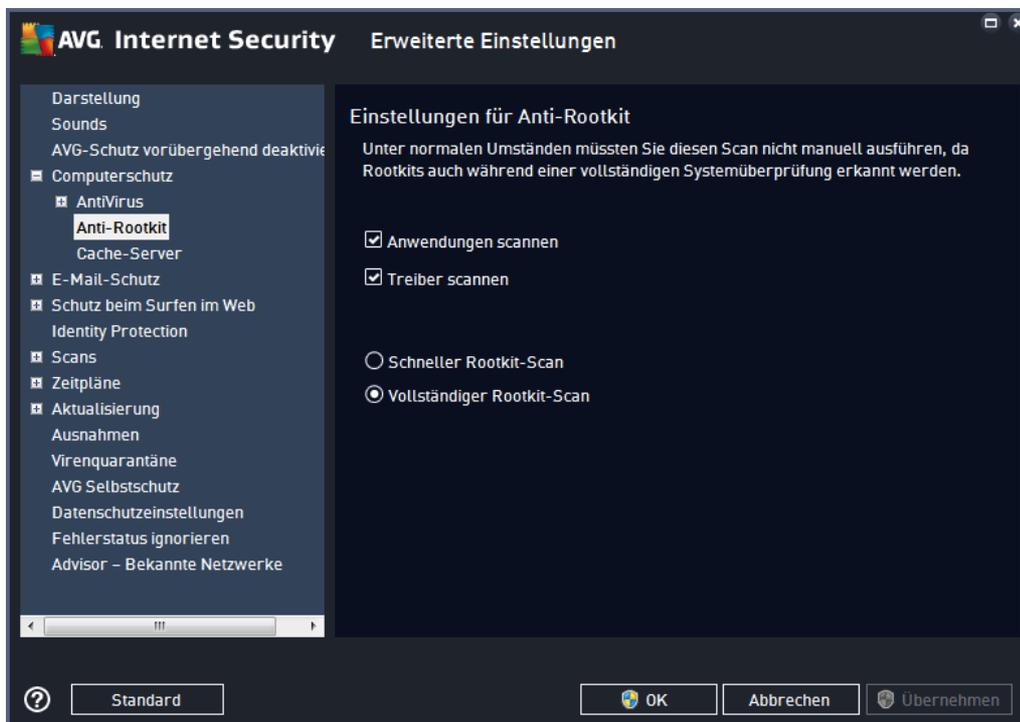
Mit **Anwendungen scannen** und **Treiber scannen** können Sie detailliert angeben, was im Anti-Rootkit-Scan enthalten sein soll. Diese Konfigurationsmöglichkeiten sind für erfahrene Benutzer gedacht. Es wird empfohlen, keine der Optionen zu deaktivieren. Sie können auch den Rootkit-Scanmodus auswählen:
