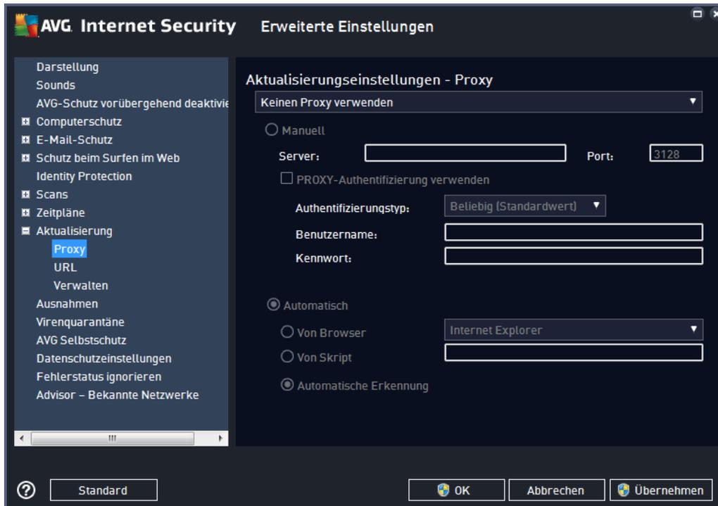
Ein Proxy-Server ist ein unabhängiger Server oder Dienst, der auf einem PC ausgeführt wird und für eine sicherere Verbindung mit dem Internet sorgt. Sie können auf das Internet entsprechend den festgelegten Netzwerkregeln entweder direkt oder über den Proxy-Server zugreifen. Es können auch beide Möglichkeiten gleichzeitig zugelassen sein. Wählen Sie anschließend im Dialog **Aktualisierungseinstellungen – Proxy** aus dem Dropdown-Menü eine der folgenden Optionen aus:
