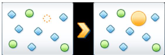
Für einen kurzen Zeitraum unmittelbar nach dem Start eines Programms (orange) wird die Rechenleistung des Computers kurzfristig umverteilt, sodass das startende Programm einen separaten Leistungsschub erhält. Dies geschieht, indem dieses Programm vorübergehend eine höhere Priorität erhält. Alle anderen Programme (grün und blau) werden nicht beeinflusst.
