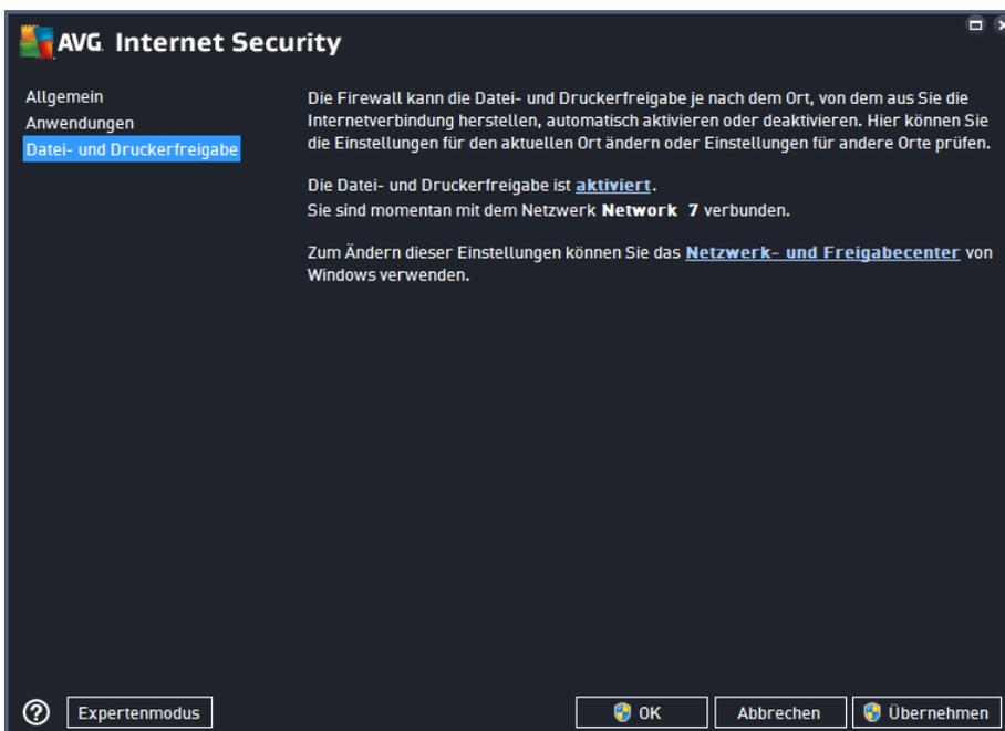
Im Dialog **Datei- und Druckerfreigabe** können Sie die Konfigurationen zur Freigabe von Dateien und Druckern und der derzeit verbundenen Netzwerke bearbeiten. Unter Windows XP entspricht der Netzwerkname der Bezeichnung, die Sie für dieses spezielle Netzwerk ausgewählt haben, als Sie zum ersten Mal eine Verbindung zu ihm hergestellt haben. Unter Windows Vista und höher wird der Netzwerkname automatisch aus dem Netzwerk- und Freigabecenter übernommen.
