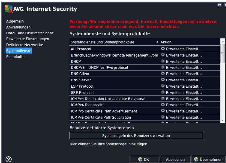
Im Dialog **Systemdienste und Systemprotokolle** werden die Standardsystemdienste und -protokolle von Windows aufgeführt, die möglicherweise über das Netzwerk kommunizieren müssen. Das Diagramm enthält die folgenden Spalten:
